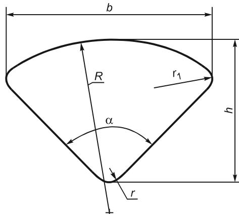
$r_1 \geq 0,5$  мм радиус закругления
