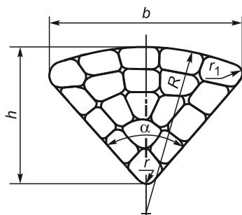
$r_1$  – радиус закругления, равный  $1/2$  диаметра проволоки
